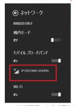
3-4 以下画面の"(ご契約されている SIM カードのキャリア名)(HSPDA)"をタップし、"自動的に接続する"のチェックボックスにチェックが入っていることを確認の上、「接続(C)」をタップします。
