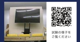
震度7直下型地震を再現し、三次元加震試験機を使用した試験\*を実施。転倒は見られず、安定性を確認しています。
